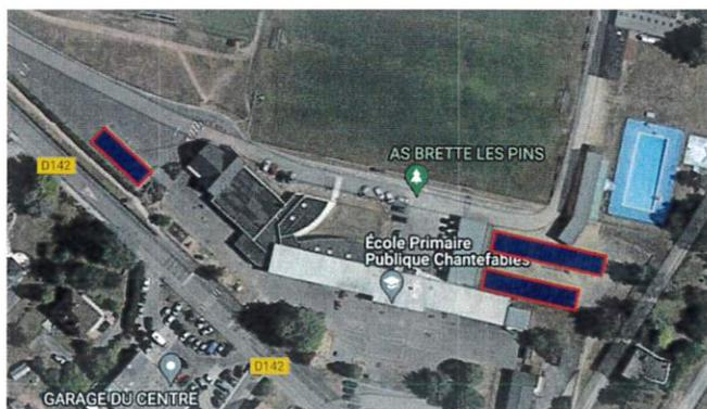
**2. Station d'épuration – Les Boutteries – 72250 Brette-les-Pins – Référence cadastrale : AL 49/AL 51.** Projet d'installation de panneaux solaires au sol représentant une surface d'environ 1 150 m<sup>2</sup>. Puissance globale de la centrale : 250 kWc.
